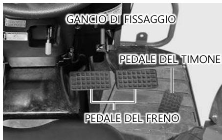
Il freno viene utilizzato per arrestare il veicolo in modo forzato.
