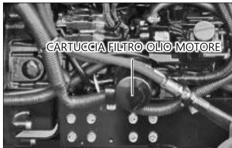
1. Rimuovere la cartuccia del filtro dell'olio motore ruotandola in senso antiorario con una chiave.
