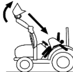
Quando si monta o si smonta il caricatore, fissare tutte le parti collegate alla benna e al braccio.
