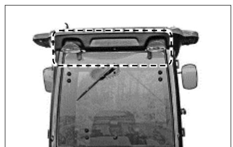
Le luci di lavoro si trovano sul tetto della cabina (due anteriori e due posteriori). L'accensione avviene tramite gli appositi interruttori sulla console del tetto.
