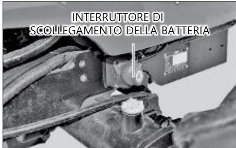
La funzione dell'interruttore staccabatteria è quella di interrompere l'alimentazione dell'impianto elettrico, interrompendo il collegamento con la batteria. Ciò comporta vantaggi soprattutto per la sicurezza e il funzionamento del trattore:
