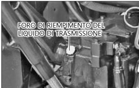
FORO DI RIEMPIMENTO DEL LIQUIDO DI TRASMISSIONE
