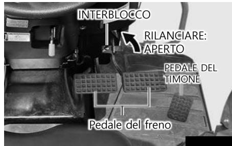
Quando sono installati due pedali del freno.
