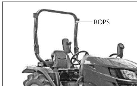
Il telaio di sicurezza ha lo scopo di ridurre i danni di un incidente in caso di ribaltamento, quindi non può impedire un incidente.
