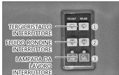
Il pannello di controllo di tergicristalli, lavavetri e luci di lavoro si trova sul lato destro dell'operatore.
