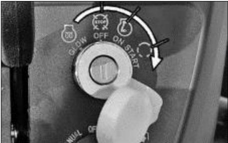
Viene utilizzato per avviare e arrestare il motore.
