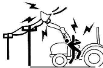
Evitare che i bracci del caricatore o l'accessorio entrino in contatto con le linee elettriche. L'elettrocuzione può causare gravi lesioni o morte.
