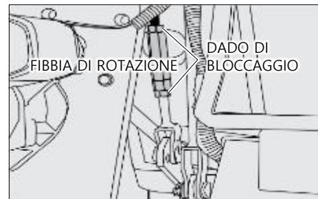
Dopo un uso prolungato del pedale della frizione, il gioco del suo cavo di trascinamento può diventare eccessivo.
